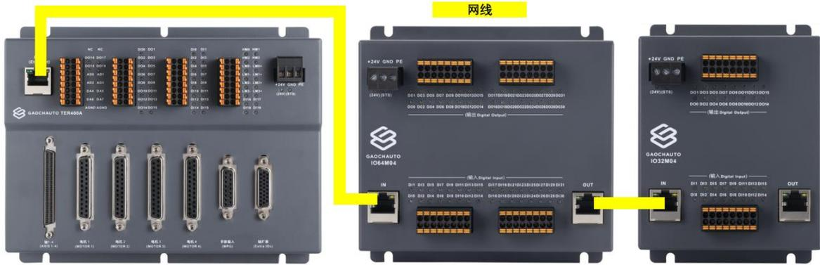
图 2.1.1 IO 模块与端子板接线示意图
