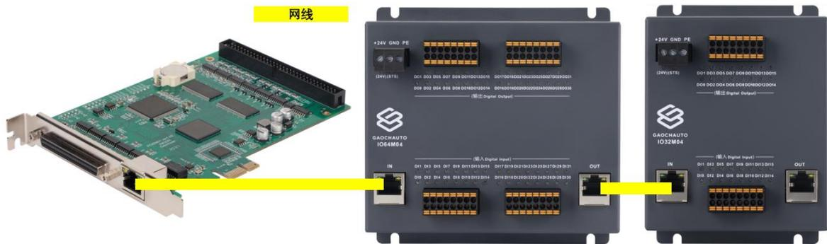
图 2.1.2 IO 模块与 GCE 控制卡接线示意图
