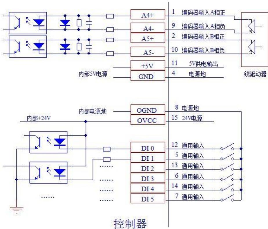
图 3.3.1 辅助编码器/手脉配线示意图
