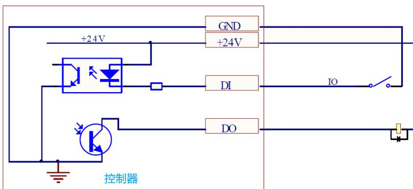
图 3.5.1 数字输入输出配线示意图
