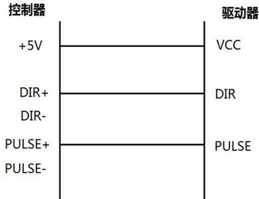
图 3.2.4 脉冲输出单端接法示意图
