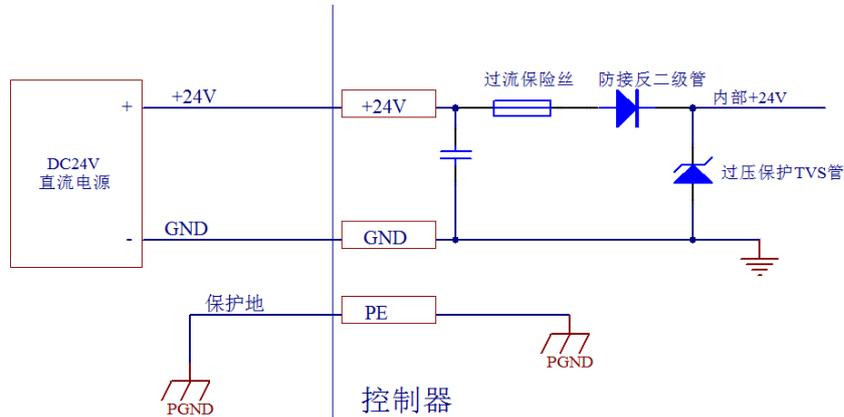
图 3.1.1 电源接口配线示意图
