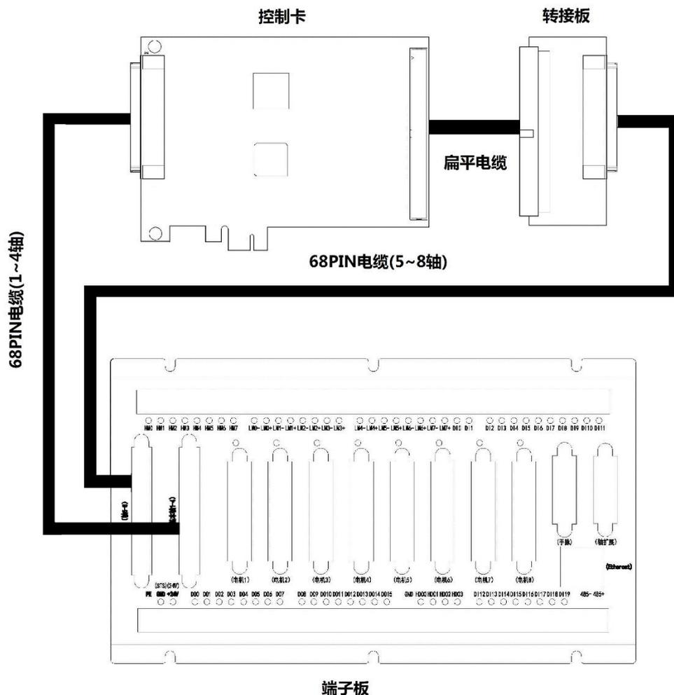
图 2.1.1 GC800A-PCIE 控制卡与端子板连接示意图
