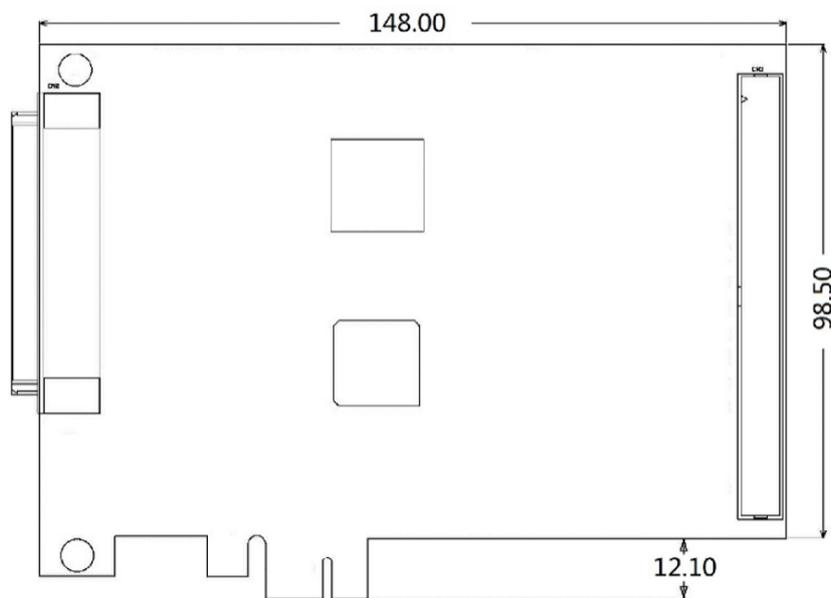
图 1.2.1 GC800A-PCIE 控制卡主卡外观及尺寸图
