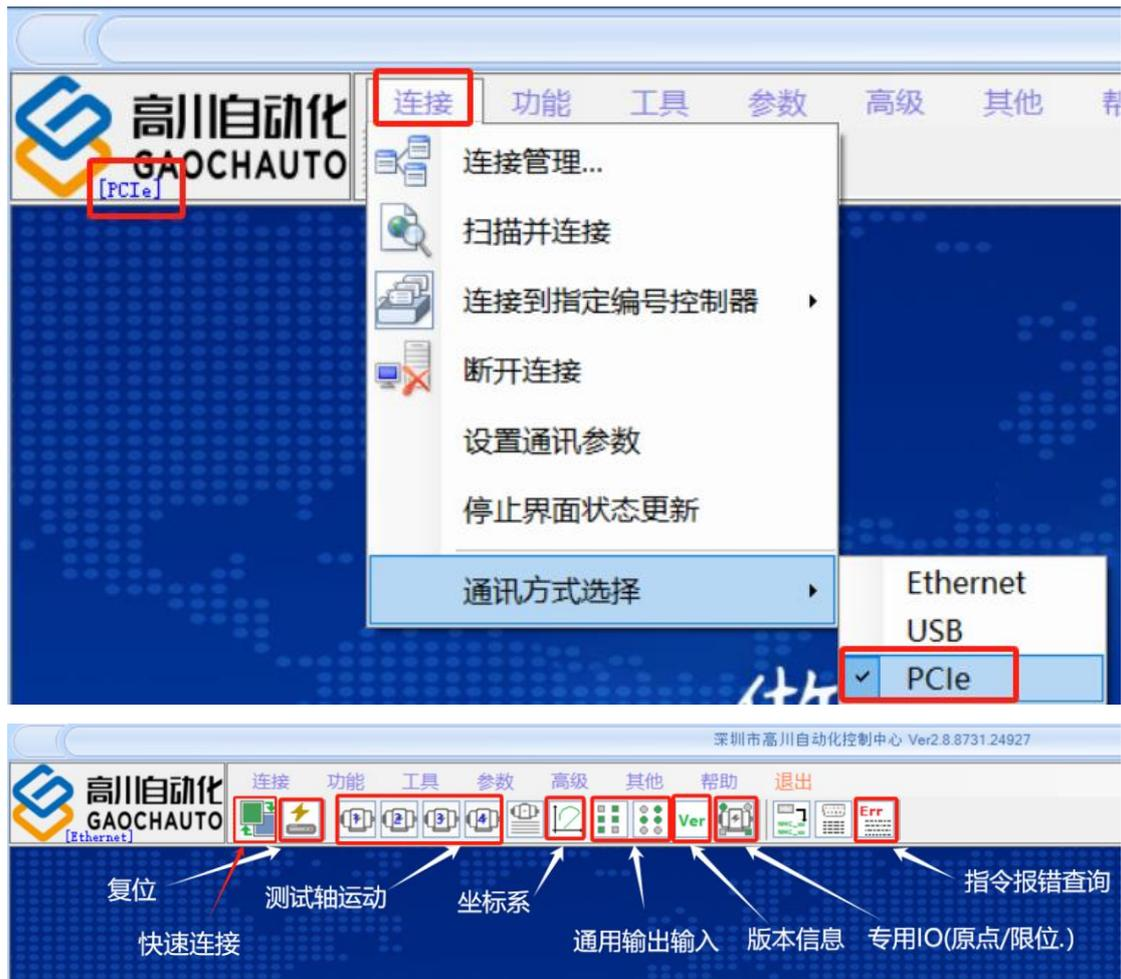
**注意：** 在 GCS 工具中，总线卡的第一个驱动器轴号为 17；自己的上位机的第一个轴号为 16；
